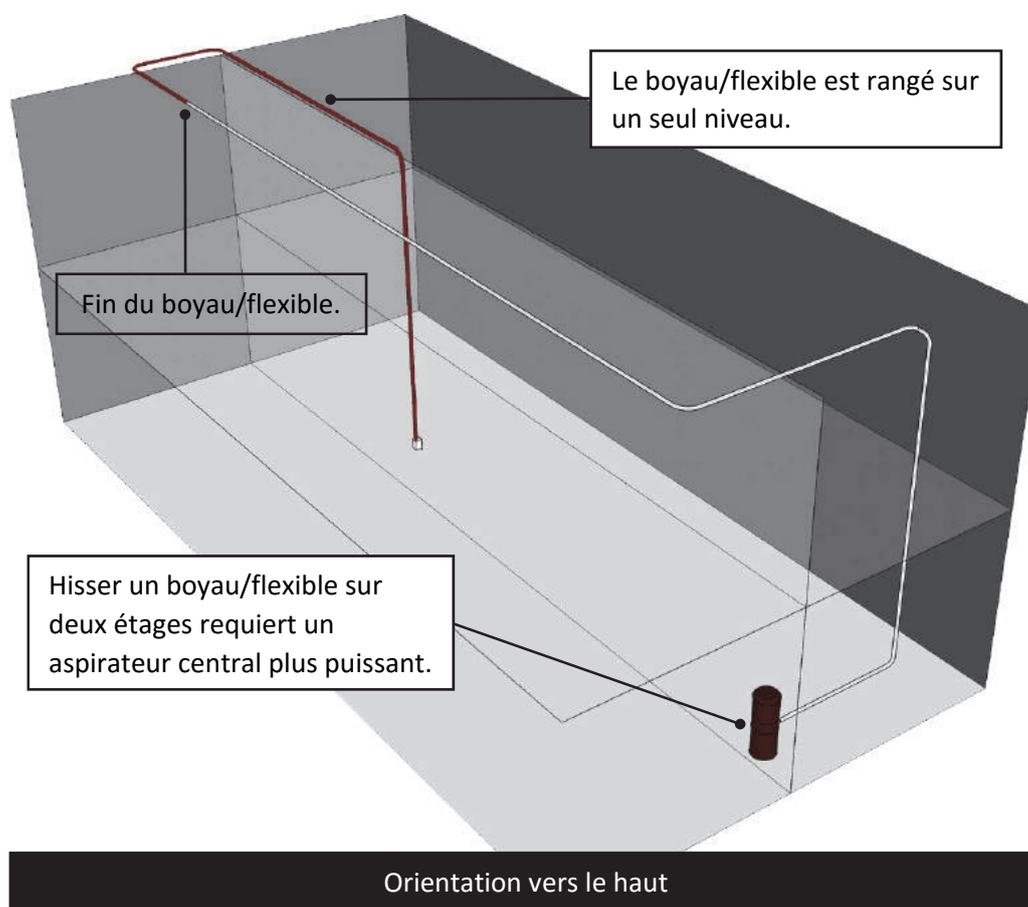
Seuls les coudes à rayon allongé conçus spécialement pour un tel système peuvent être utilisés dans l'espace où le boyau/flexible se rétracte (coudes 90°, 45° et 22,5°).
