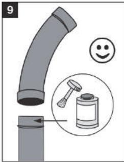
Tout excédent de colle peut occasionner des accrocs ou endommager la housse du boyau/flexible lorsqu'il se rétracte dans les conduits. Pour éviter ce problème, appliquer la colle sur les embouts mâles, et non femelles (figure 9).
