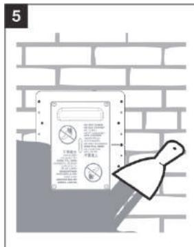
Insérer le derrière de la prise dans le mur, et fixer la prise directement sur la brique (figure 5). Une fois le système de conduits et les fils bas voltage raccordés, sceller l'arrière de la prise dans le mur en remplissant de plâtre.
