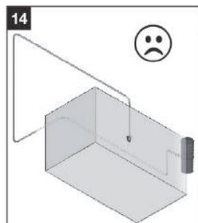
Éviter une installation réalisée sur deux étages (figure 14).
