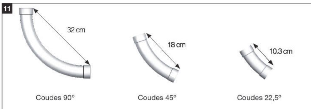
Plus vous utilisez de coudes 90°, plus vous aurez besoin de force pour déployer le boyau/flexible du mur. Dans la mesure du possible, n'utilisez pas plus de quatre coudes 90° par prise.
