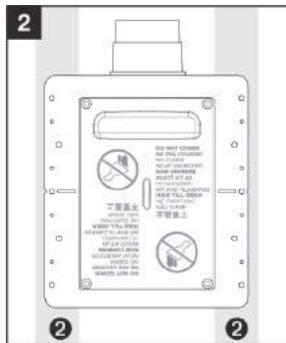
Nous recommandons d'ajouter un montant ou rail (2x4) ❷ de l'autre côté pour bien fixer la prise en place (figure 2).
