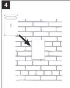
Utiliser comme model la plaque de recouvrement jaune pour faire une ouverture dans la brique (figure 4).
