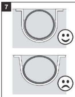
Lors de l'installation des supports à tuyau pour fixer la tuyauterie en place, s'assurer de ne pas comprimer les conduits (figure 7) pour ne pas altérer le mouvement du boyau à l'intérieur du système.
