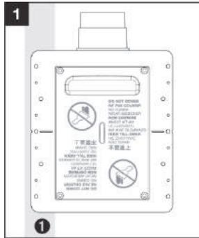
Fixer la prise au montant ou rail (2x4) ❶. S'assurer que la plaque soit de niveau (figure 1) et qu'il y ait 7.6 cm de libre derrière la prise.
