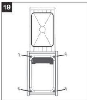
Puis, ouvrir la porte et insérer les vis dans les 4 coins (figure 19) pour bien fixer la pièce en place. Ajuster les 4 vis pour que la porte ferme bien.
