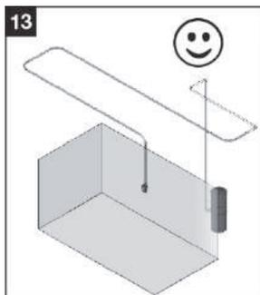
Il est important de créer un parcours de conduits permettant de ranger le boyau/flexible sur un seul niveau (figure 13).
