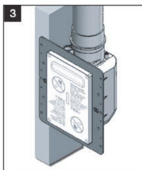
Installer le conduit de PVC dans le raccord (figure 3). Coller le conduit dans le raccord et s'assurer qu'il est bien inséré au fond de celui-ci (voir Parcours des conduits).
