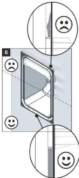
S'assurer que l'épaisseur du recouvrement de plâtre soit de niveau avec l'épaisseur de la prise (environ 1 cm), et ce, tout autour de la prise (figure 6).
