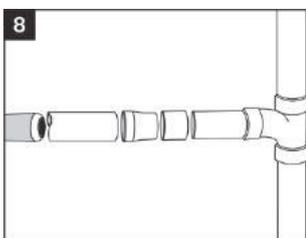
Raccorder un réducteur 2" - 1,825" (TF5532BV) avant le raccordement à la ligne principale pour prévenir tout blocage du boyau. (figure 8)
