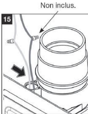
Connecter les deux fils conducteurs de l'interrupteur (situés sur le haut de la prise) au fil bas voltage du système de conduits (figure 15).
