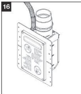
Faites passer le fil bas voltage dans la gaine électrique type ITCA (vendue séparément), comme pour n'importe quelle autre installation d'aspirateur central et tirer la gaine par-dessus les fils de la prise puis dans l'ouverture dédiée (figure 16).
